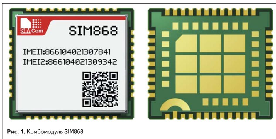
Рис. 1. Комбомодуль SIM868
