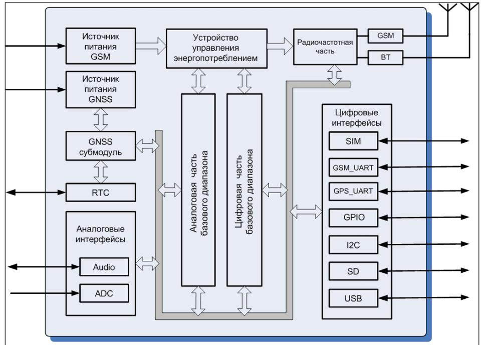
Рис. 2. Функциональная схема комбomodуля SIM868
