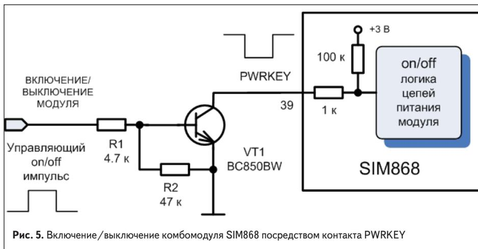
Рис. 5. Включение/выключение комбomodуля SIM868 посредством контакта PWRKEY
