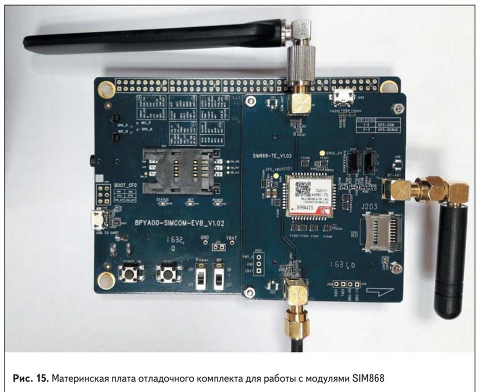
Рис. 15. Материнская плата отладочного комплекта для работы с модулями SIM868
