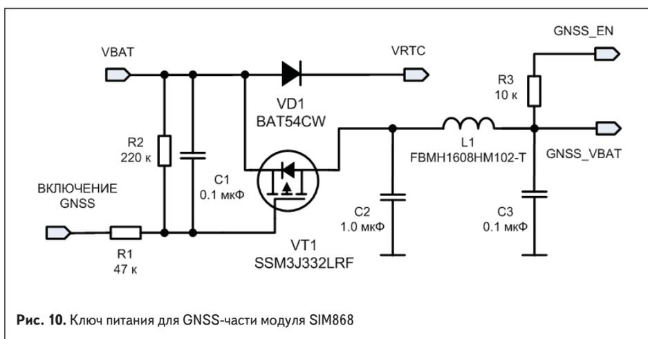
Рис. 10. Ключ питания для GNSS-части модуля SIM868
