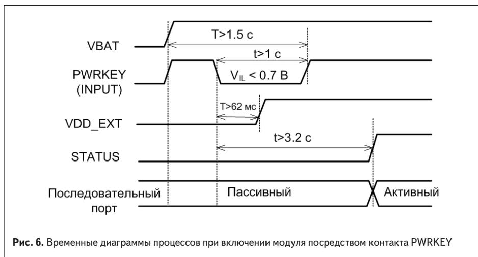
Рис. 6. Временные диаграммы процессов при включении модуля посредством контакта PWRKEY
