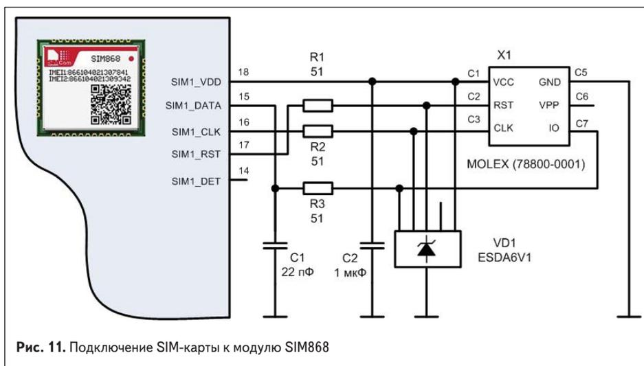
Рис. 11. Подключение SIM-карты к модулю SIM868
