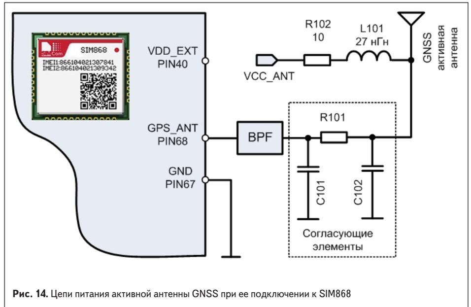
Рис. 14. Цепи питания активной антенны GNSS при ее подключении к SIM868
