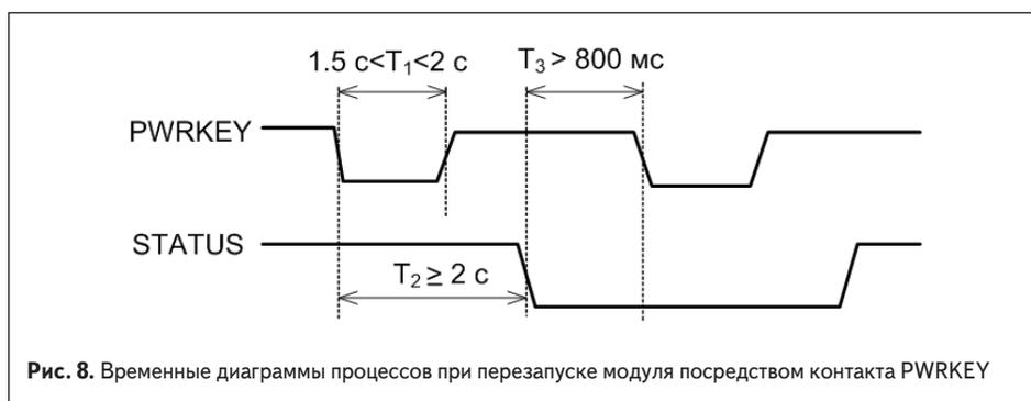
Рис. 8. Временные диаграммы процессов при перезапуске модуля посредством контакта PWRKEY
