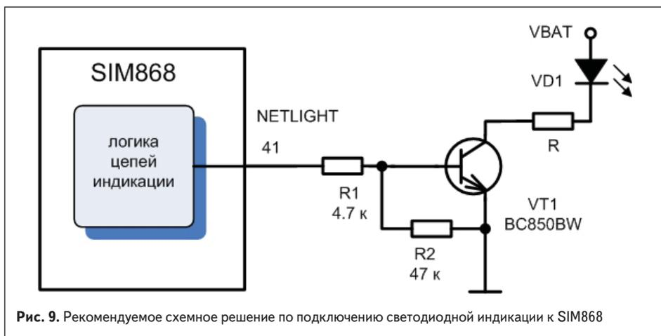
**Рис. 9.** Рекомендуемое схемное решение по подключению светодиодной индикации к SIM868
