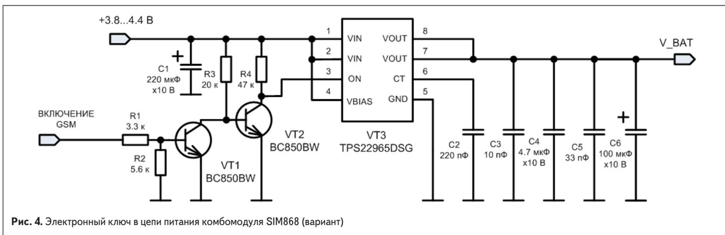
Рис. 4. Электронный ключ в цепи питания комбomodуля SIM868 (вариант)
