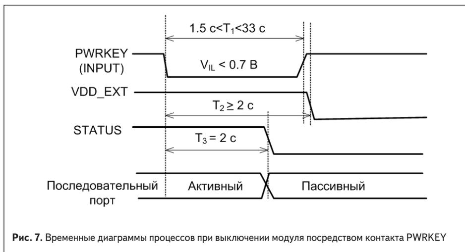
Рис. 7. Временные диаграммы процессов при выключении модуля посредством контакта PWRKEY
