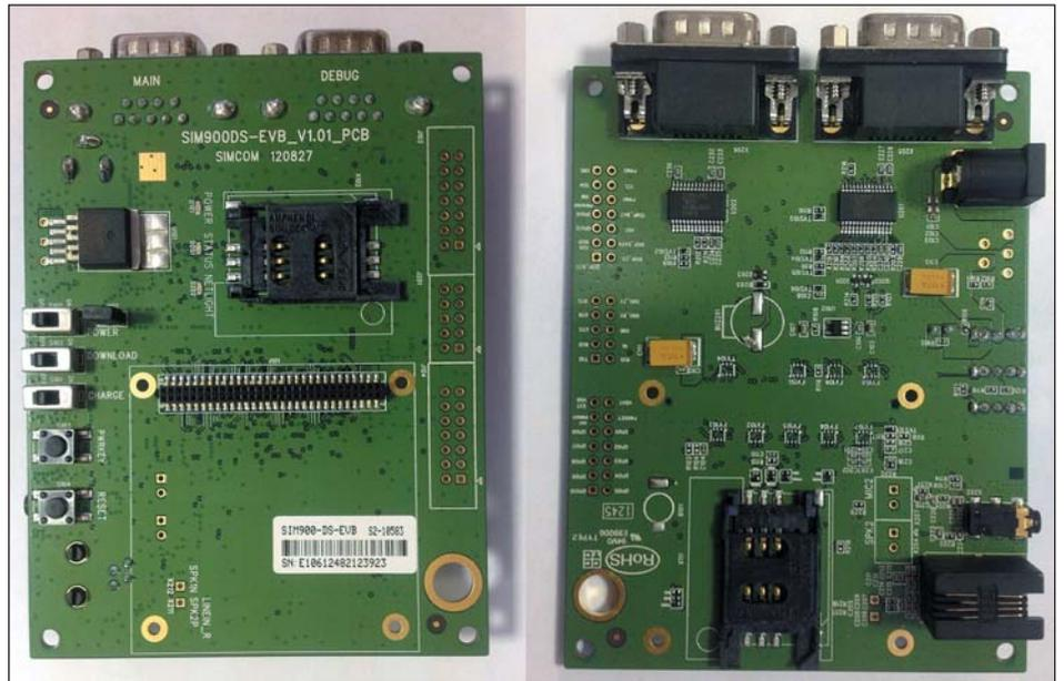
Рис. 4. Лицевая и обратная сторона отладочной платы SIM900-DS\_EVB
