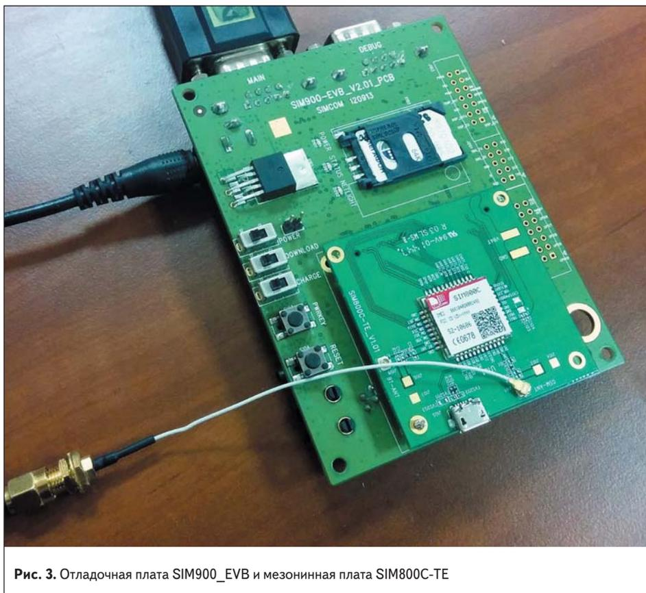
Рис. 3. Отладочная плата SIM900\_EVB и мезонинная плата SIM800C-TE
