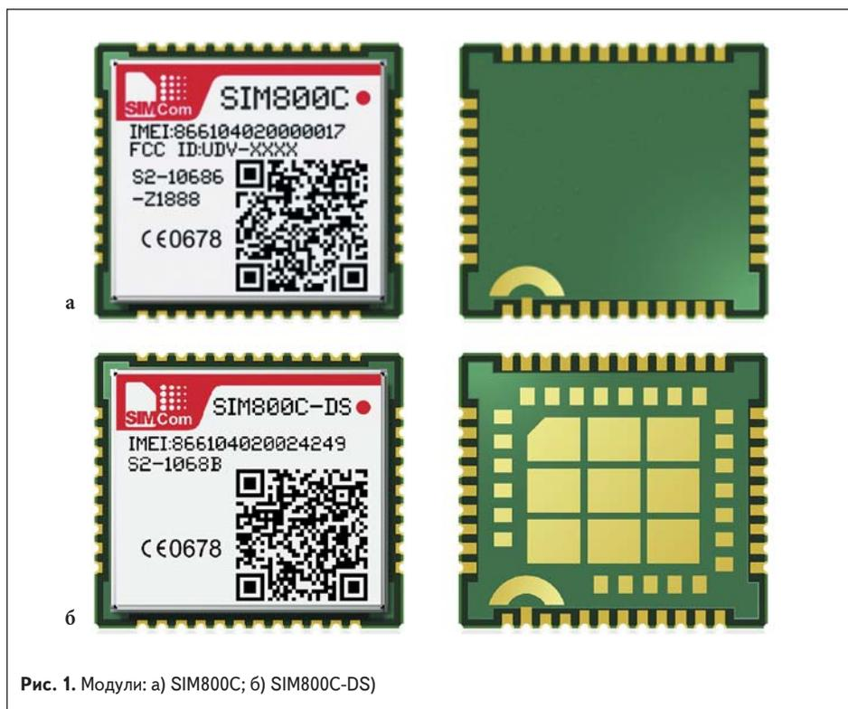
Рис. 1. Модули: а) SIM800C; б) SIM800C-DS
