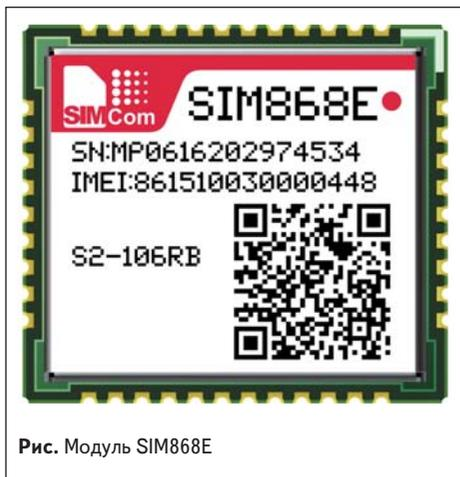
Рис. Модуль SIM868E
