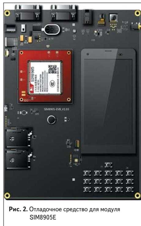
Рис. 2. Отладочное средство для модуля SIM8905E
