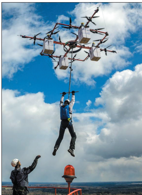
Рис. 15. Транспортировка людей в труднодоступные места на грузовом дроне
