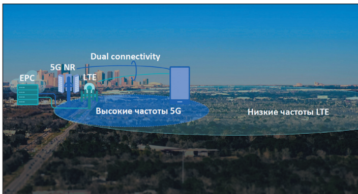
Рис. 30. Подключение UE к LTE ng-eNB и 5G gNB в режиме EN-DC
