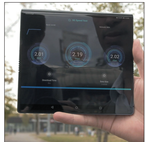
Рис. 26. Тестирование скорости скачивания (1,3 Гбит/с) на смартфоне Huawei Mate X в сети оператора «Билайн» (Москва)
