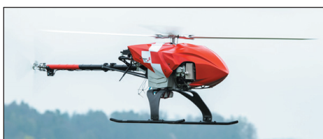
Рис. 18. Спасательно-поисковый дрон швейцарской авиационно-спасательной организации Rega, самостоятельно ищущий людей
