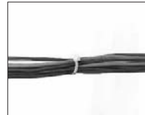
4. Установленная стяжка крепко удерживает кабели.
