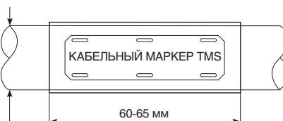
После усадки на кабельном маркере TMS
